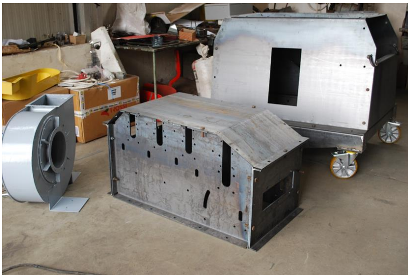
Realizarea carcasei prin tăiere cu laser și îndoire
