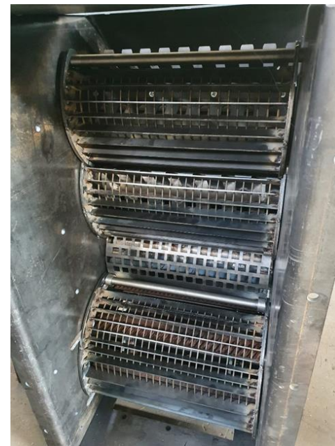
Realizarea bățătoarelor și contrabățătoarelor utilizate pentru condiționarea cânepii
