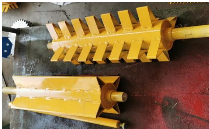
Realizarea bățătoarelor și contrabățătoarelor utilizate pentru condiționarea cânepii
