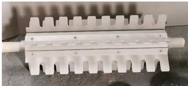
Realizarea carcasei prin tăiere cu laser și îndoire
