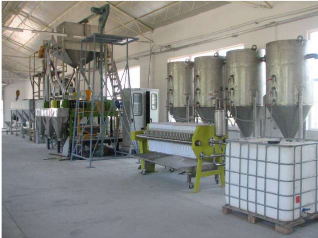
Fig. 1 Instalația de obținere uleiuri vegetale, 150 l/h
