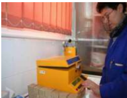
Fig. 28 – Determinarea puterii calorice a uleiului tip FINAL BIOFLUM, contaminat cu praf de rumeguș, particule fine de pământ, frunze și apă
