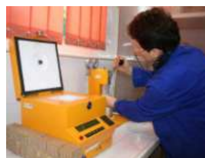
Fig. 23 – Determinarea puterii calorice a uleiului tip FINAL BIOFLUM, contaminat cu praful de rumeguș, particule fine de pământ și particule fine de frunze
