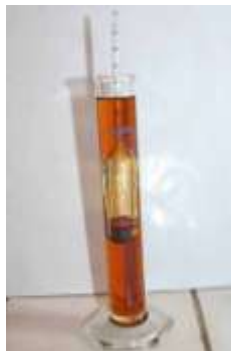
Fig. 1 – Determinarea densității uleiului
