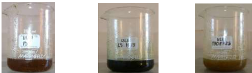
Fig. 29 – Contaminarea cu particule fine de frunze (adăugate după praful de rumeguș și particule fine de pământ) a uleiului tip BF, LS HUS și T 90 EP 2S
