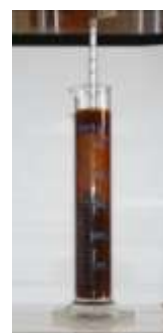
Fig. 25 – Determinarea densității uleiului tip FINAL BIOFLUM, contaminat cu praful de rumeguș, particule fine de pământ, frunze și apă
