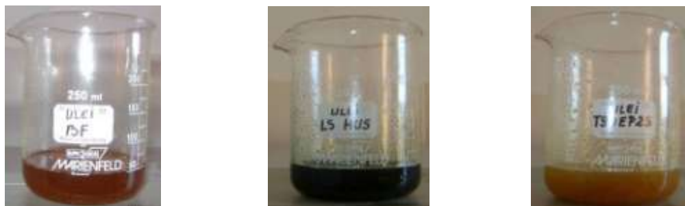
Fig. 25 – Contaminarea cu particule fine de pământ (adăugate după praful de rumeguș) a uleiului tip BF, LS HUS și T 90 EP 2S
