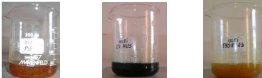
Fig. 23 – Contaminarea cu praf de rumeguș a uleiului tip BF, LS HUS și T 90 EP 2S
