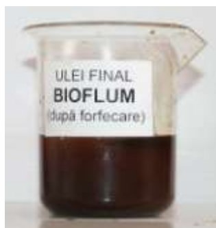
Fig. 24 – Contaminarea cu particule de apă (adăugate după praful de rumeguș, particule fine de pământ și frunze) a uleiului tip FINAL BIOFLUM
