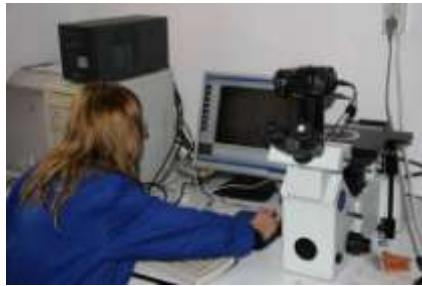
Fig. 9 – Determinarea petei de contact cu microscopul metalografic inversat tip GX51
