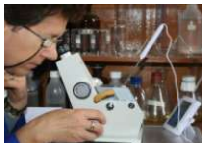
Fig. 27 – Determinarea indicelui de refracție al uleiului tip FINAL BIOFLUM, contaminat cu praf de rumeguș, particule fine de pământ, frunze și apă
