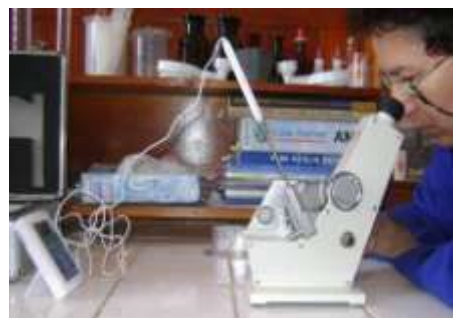
Fig. 14 – Determinarea indicelui de refracție al uleiului tip FINAL BIOFLUM, contaminat cu praf de rumeguș
