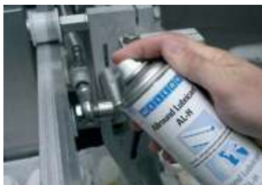
Lubrifierea unor rulmenți
