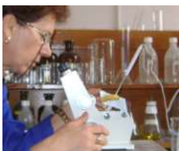
Fig. 22 – Determinarea indicelui de refracție al uleiului tip FINAL BIOFLUM, contaminat cu praful de rumeguș, particule fine de pământ și particule fine de frunze
