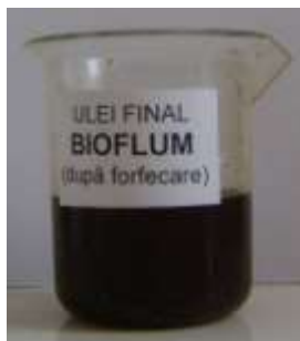
Fig. 15 – Contaminarea cu particule fine de pământ (adăugate după praful de rumeguș) a uleiului tip FINAL BIOFLUM
