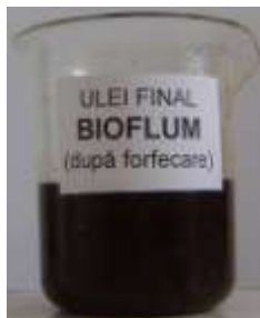
Fig. 11 – Contaminarea cu praf de rumeguș a uleiului tip FINAL BIOFLUM
