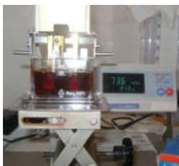
Fig. 21 – Determinarea viscozității uleiului tip FINAL BIOFLUM, contaminat cu praful de rumeguș, particule fine de pământ și particule fine de frunze
