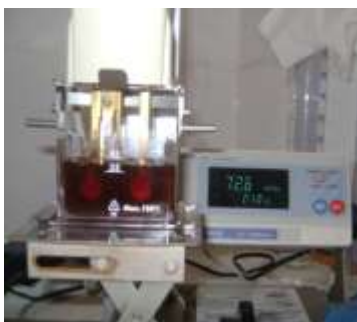
Fig. 13 – Determinarea viscozității uleiului tip FINAL BIOFLUM, contaminat cu praf de rumeguș
