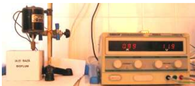
Fig. 6 – Ulei tip BAZĂ BIOFLUM supus forfecării
