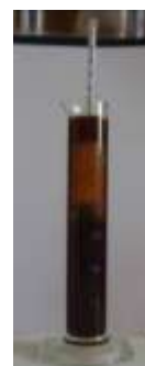
Fig. 20 – Determinarea densității uleiului tip FINAL BIOFLUM, contaminat cu particule fine de pământ și praful de rumeguș
